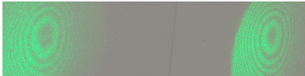
Abbildung 4: Nicht-Komplementäre Ausgänge des MZI. Bei Basiswahl P_A : 0^\circ und P_B : 90^\circ zeigen sich an den Ausgängen des Interferometers Intensitätsverläufe die bei herkömmlicher Interferenz dem Energiesatz widersprechen.
